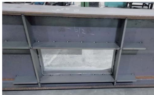
Fig. 7 - Modello FEM per lo studio dei rinforzi dei fori nelle travi HEA1000 e fase realizzativa in officina
