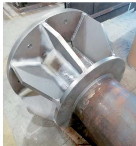
Fig. 7 - Modello FEM per lo studio dei rinforzi dei fori nelle travi HEA1000 e fase realizzativa in officina
